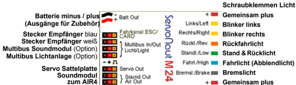
Das Typenschild auf der Unterseite ist auch gleichzeitig Kühlkörper. Der M24 wird im Betrieb warm und braucht ggf. etwas Kühlung, deshalb für Belüftung sorgen und nicht mit Schaumstoff o.ä. umwickeln!
