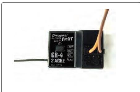
Stecken Sie das Adapter-Kabel in die Telemetriebuchse (Buchse 3) des Empfängers. Das Stecksystem ist verpolungssicher, achten Sie auf die kleinen seitlichen Fasen. Wenden Sie auf keinen Fall Gewalt an, der Stecker sollte leicht einrasten.
