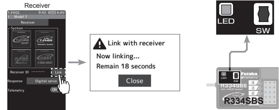
5. Während des laufenden Countdowns, am Empfänger den Link-Taster für ca. 2 Sekunden gedrückt halten, die LED beginnt abwechselnd rot - grün zu blinken und es erscheint im Sender Display die Meldung "Link with receiver". Link-Taster am Empfänger jetzt loslassen. Nach erfolgter Bindung, leuchtet die LED dauerhaft grün.
