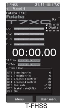
Response Mode wird angezeigt "Digital servo" "Analog servo"
